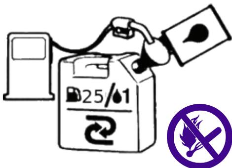
Mezcle gasolina de grado regular (sin plomo, sin alcohol) y un aceite de motor de calidad probada para Motores refrigerados de 2 tiempos.
