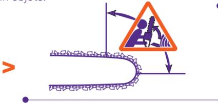
El freno de cadena (A) se activa bien manualmente (con la mano izquierda) o por efecto de la inercia.
