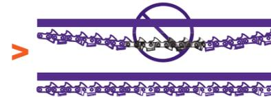
¡Mantenga el equipo de corte bien lubricado y efectúe el mantenimiento adecuado! Con una lubricación insuficiente se incrementa el riesgo de roturas de cadena y se aumenta el desgaste de la espada, la cadena y el piñón de arrastre.
