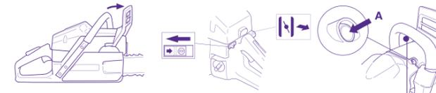
Si la máquina tiene una válvula de descompresión (A), oprima la válvula para reducir la presión en el cilindro y facilitar el arranque de la máquina. La válvula de descompresión debe utilizarse siempre para los arranques. Una vez que ha arrancado la máquina, la válvula vuelve automáticamente a la posición de partida.
