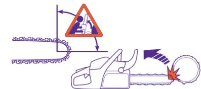
El corte con la parte inferior de la espada, en sentido descendente desde la parte superior del objeto a cortar, se denomina de corte con cadena tirante. La motosierra es tirada hacia el árbol y el canto delantero del cuerpo se apoya contra el tronco. Con esta técnica de cadena tirante, el usuario controla mejor la motosierra y la situación del sector de riesgo del rebote de la espada.
